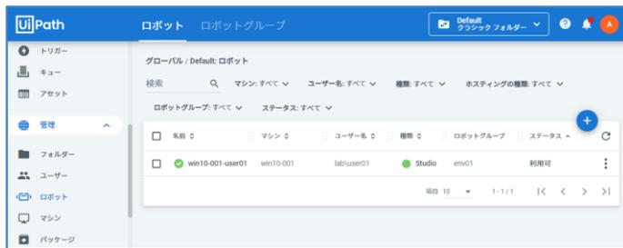
クラシックフォルダーでは Orchestrator 上でマシンキーを作成したマシンを使用して標準ロボットを登録し、状態が利用可能と表示されることを確認します。
