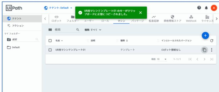
Orchestrator から UiPath Robot / Studio に接続するには、Orchestrator 管理コンソールでロボットのプロビジョニングを行います。
